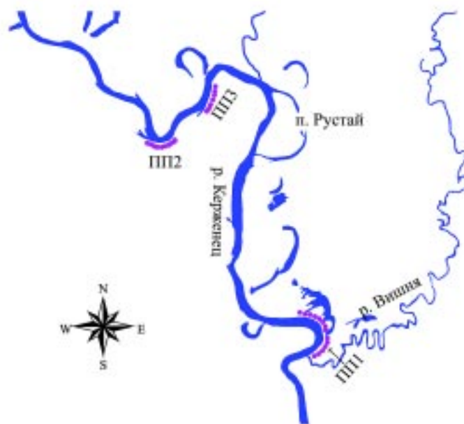
Рис. 2. Участок русла р. Керженец с пробными стационарными площадками (ПП1, ПП2, ПП3), по которым определяется интенсивность размыва берегов
